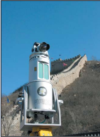
Laser scanner Z620 montato e posizionato per il rilievo
